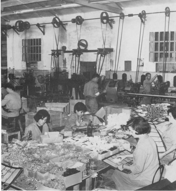
Imagen 3.1.5.3- El montaje - "engafe" - (VALERO ESCANDELL, J.R. 1991)
