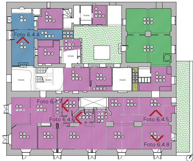
Plano 6.4.2 - Planta Primera. Patologías en techos
