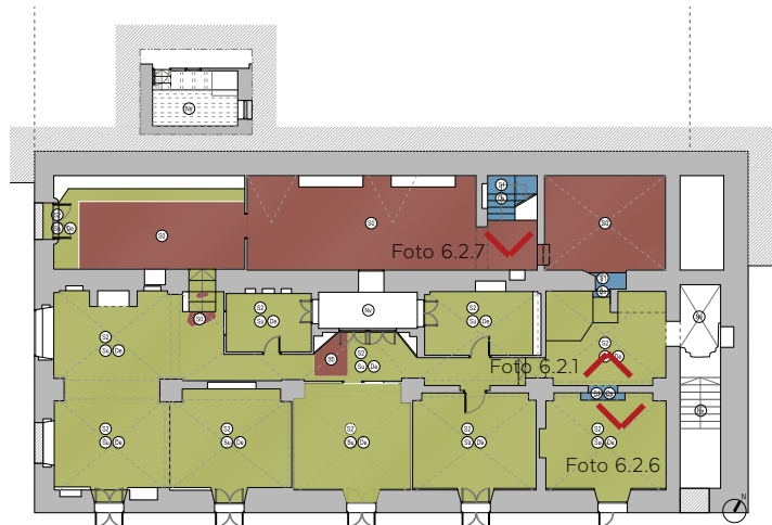
Plano 6.2.1 - Planta Baja. Patologías en pavimentos
