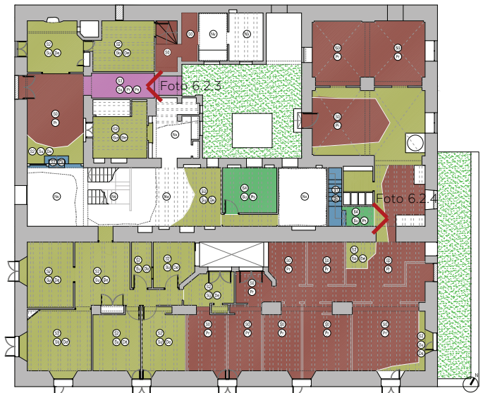
Plano 6.2.2 - Planta Primera. Patologías en pavimentos
