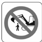
SP-220 PROHIBIDO CIRCULAR O PERMANECER EN EL RADIO DE ACCIÓN DE LA EXCAVADORA
