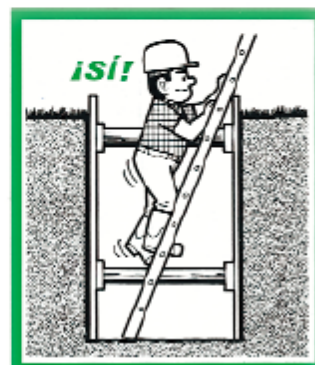
Utilizar escaleras de mano para acceder al fondo de la zanja y volver a salir.
