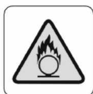
SA-020 ¡PELIGRO! MATERIAL COMBURENTE
