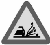
TP-28 PROYECCION DE GRAVILLA
