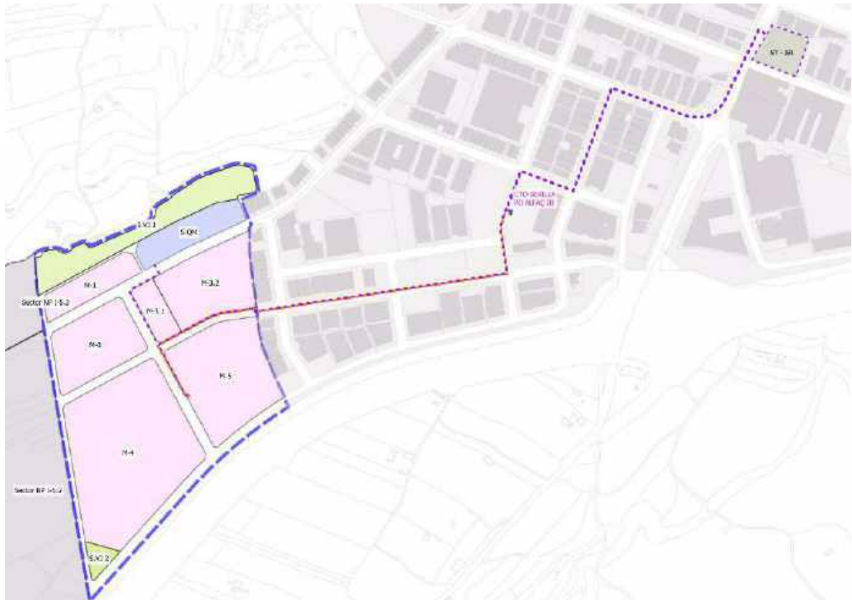
Ilustración 2 Subestación, Sector y canalización suministro. Fuente: Elaboración propia
