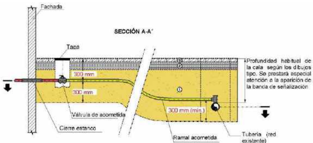
Ilustración 4 Zanja tipo para Acometidas con tallo en fachada. Fuente: Condiciones Particulares Nedgia Cegas, S.A.
