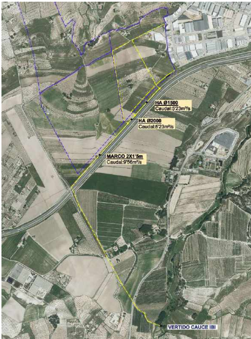
Ilustración 4 Canalización hasta cauce público. Fuente: Elaboración propia
